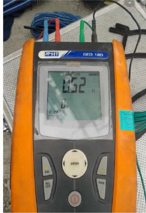
Resim2: HB inşaata ait topraklama
